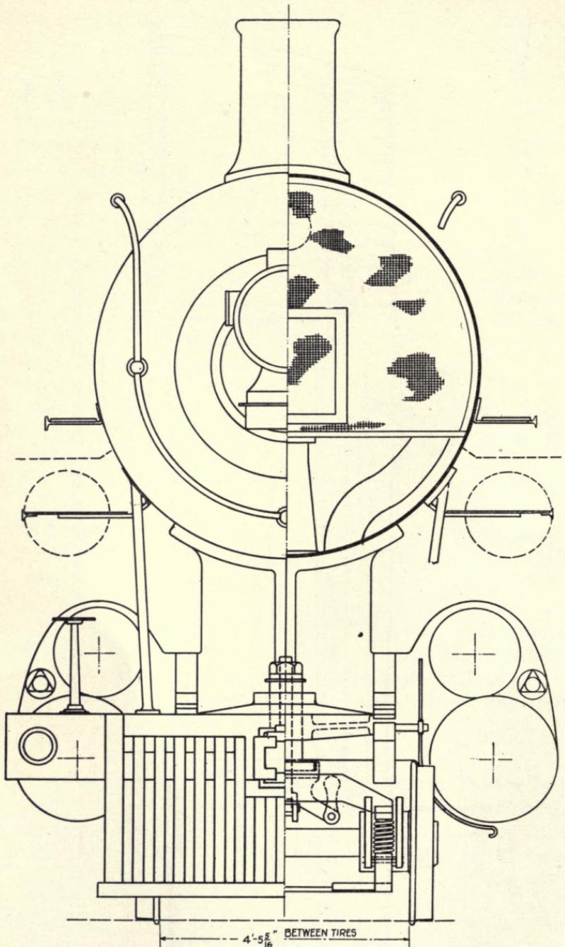
FIG. 42. FRONT ELEVATION OF THE LOCOMOTIVE.
